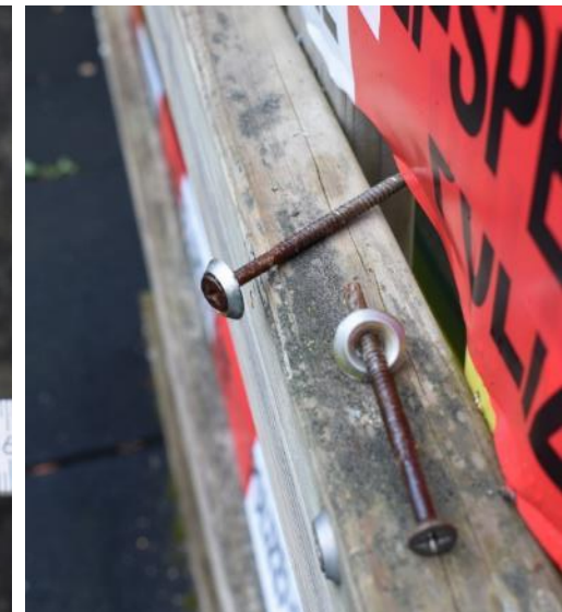
Original Schrauben, stark korrodiert
